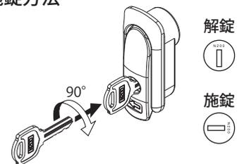
施錠は取手を閉じてキー(付属品)を向きに注意して挿入し、矢印の方向へ90°回してください。
