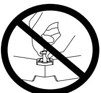
ドアの開閉角度は約105°です。ドアを開けた状態で右図の矢印方向にさらに荷重を掛けないでください。蝶番部およびドアの変形・破損の原因になります。
