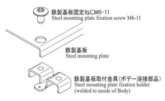
※ボックスサイズによって、対角2点止めと4点止めとがあります。 We have two-point fixed in opposing corner and four-point fixed type, depending on the size of the enclosure.
