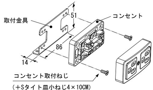
② 取付金具を格子形状ボデーの機器取付穴、または木製基板に取付けてください。金具取付ねじは格子形状ボデー用と木製基板用がありますので、取付部に合ったねじをご使用ください。
