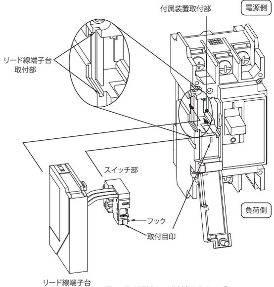
図2 取付例(リード線端子台タイプ)
