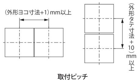
2. 付属の取付金具およびばね座金 M6、取付ナット M6 を使用して、キャビネットに確実に固定してください。(図 2)
