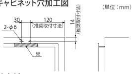
※穴加工の際、キャビネットのボデー水切り面が傷つかないよう、 斜線部を養生テープなどで保護してください。
