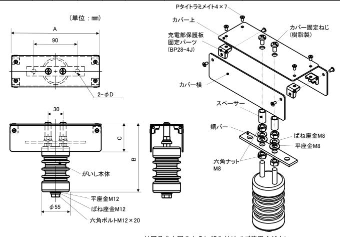
付属品を上図のように組み付けてご使用ください。 カバーは、配線完了後に組み付けてください。 再度、配線を行う場合はカバーを取り外してから行ってください。
