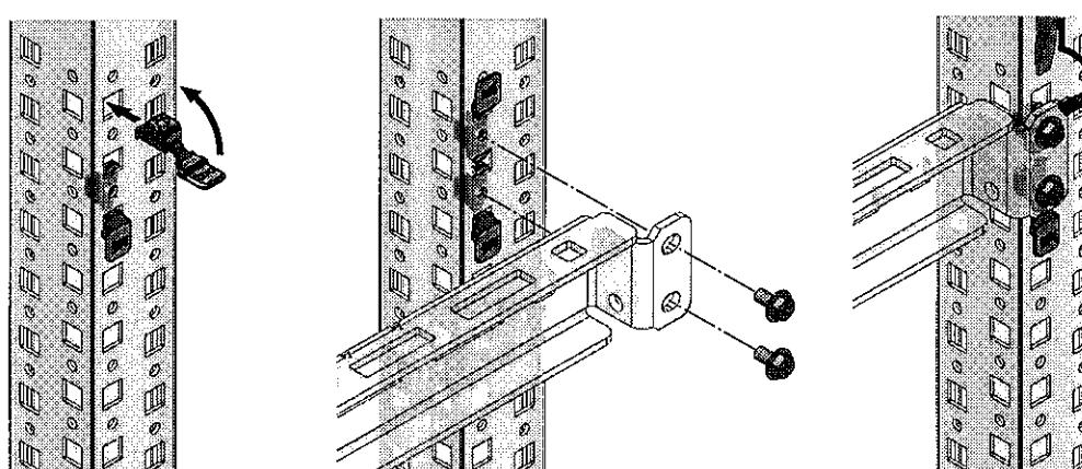
各種取付ねじは右表の適正トルク値を守り正しく締付けてください。
