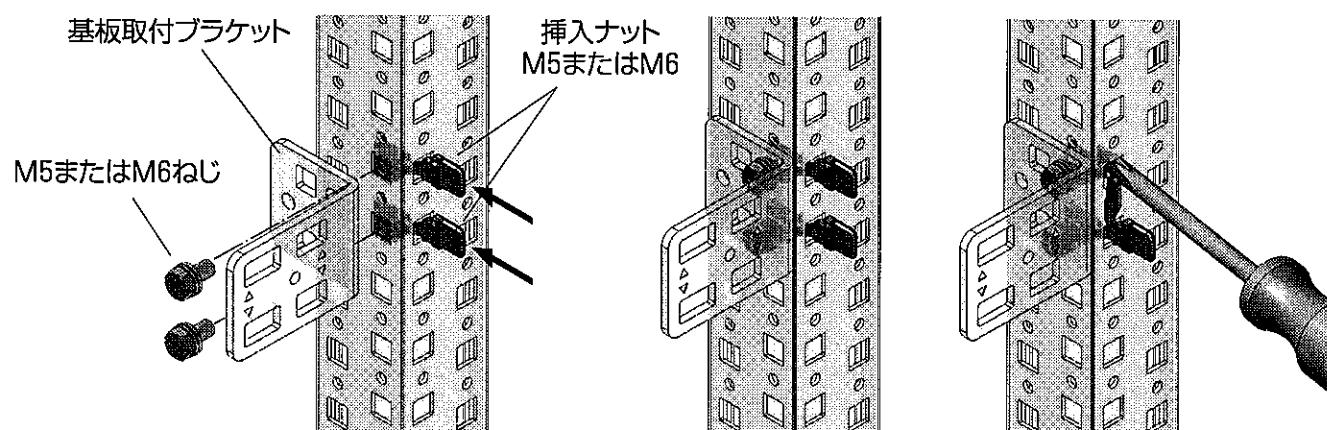
各種取付ねじは右表の適正トルク値を守り正しく締付けてください。
