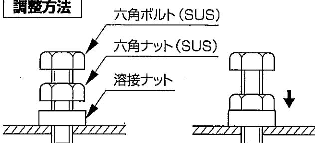
付属の六角ボルトに六角ナットを取り付け、基台底面の溶接ナットにボルトをネジ込んでいき、設置面が平行になるようしてください。
